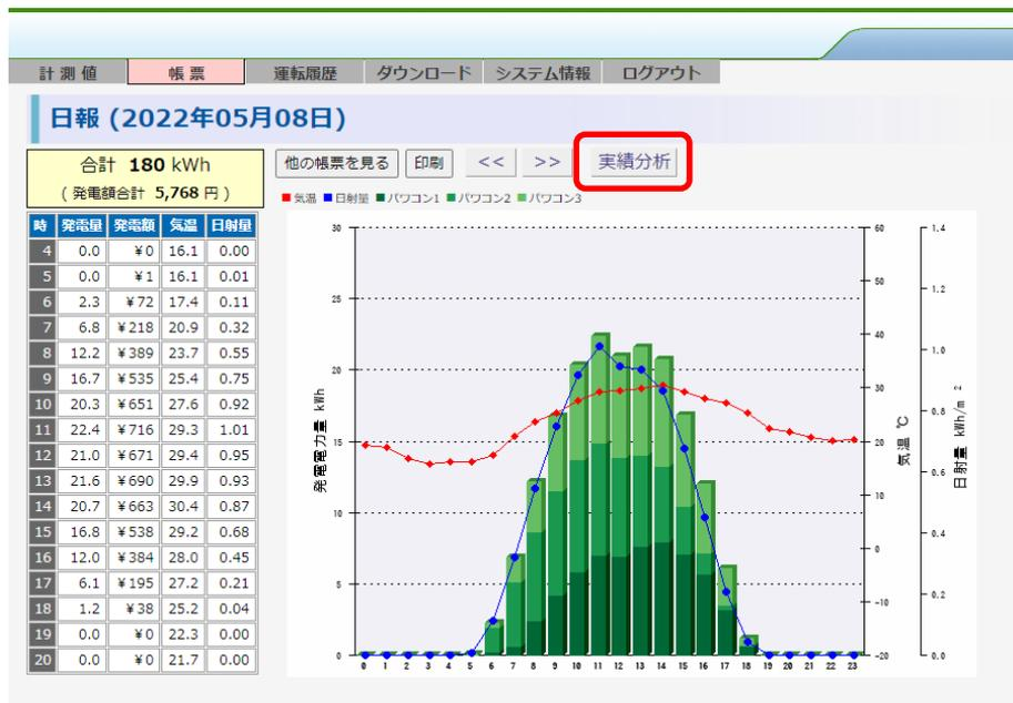
実績分析では日射量と発電量の過去の実績を用いて、「この日射量であれば発電量が期待できる発電量（期待発電量）」を計算し、その期待発電量と実際の発電量を比較し「期待差（期待発電量と実際の発電量の差）」を表示します。
